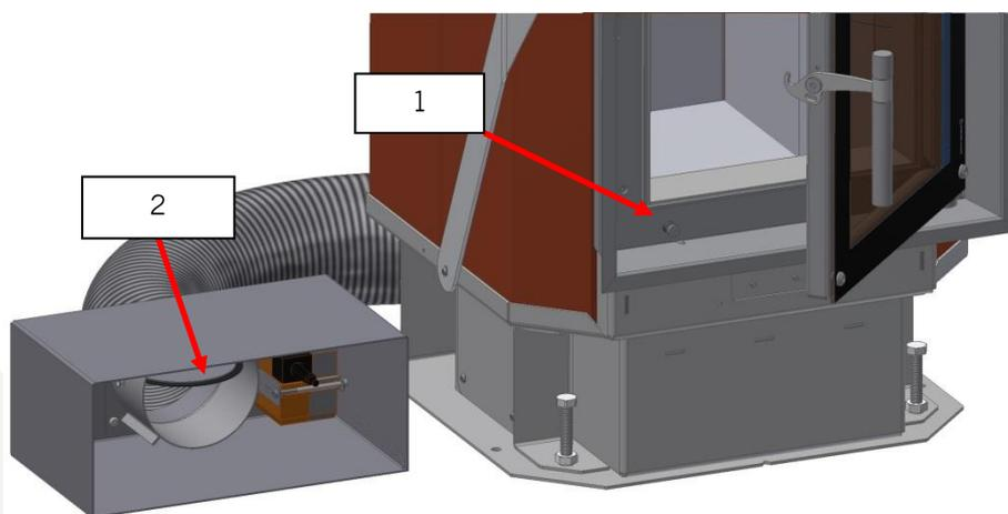
Beim Öffnen der Doppelglasscheibe reagiert der **Türknotaktschalter** (1) und sendet ein Signal zur Abbrandsteuerung. Die Steuerung erkennt, dass sich die Tür geöffnet hat und aktiviert den Luftklappenstellmotor, die **Zuluftklappe** (2) öffnet sich.
