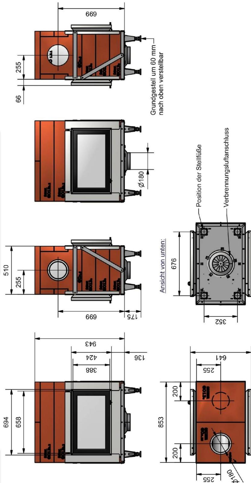
Alle Höhenangaben gelten bei einer Mörtelfugenstärke von 3 mm, einer Faserplattenstärke von 3 mm (im zusammengepressten Zustand) und vollständig nach unten geschraubtem Grundgestell.
