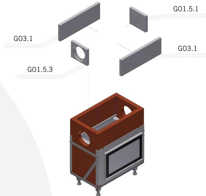
Versetzen Sie die Teile der Nachverbrennungskammer trocken. Bei nicht geschlossenen Fugen (abhängig von der Fugenstärke beim Aufbau der roten Mantelsteine) sind die Fugen mit Keramikfaser abzudichten. Die Nachverbrennung jedoch nicht untereinander zu Verkleben.
