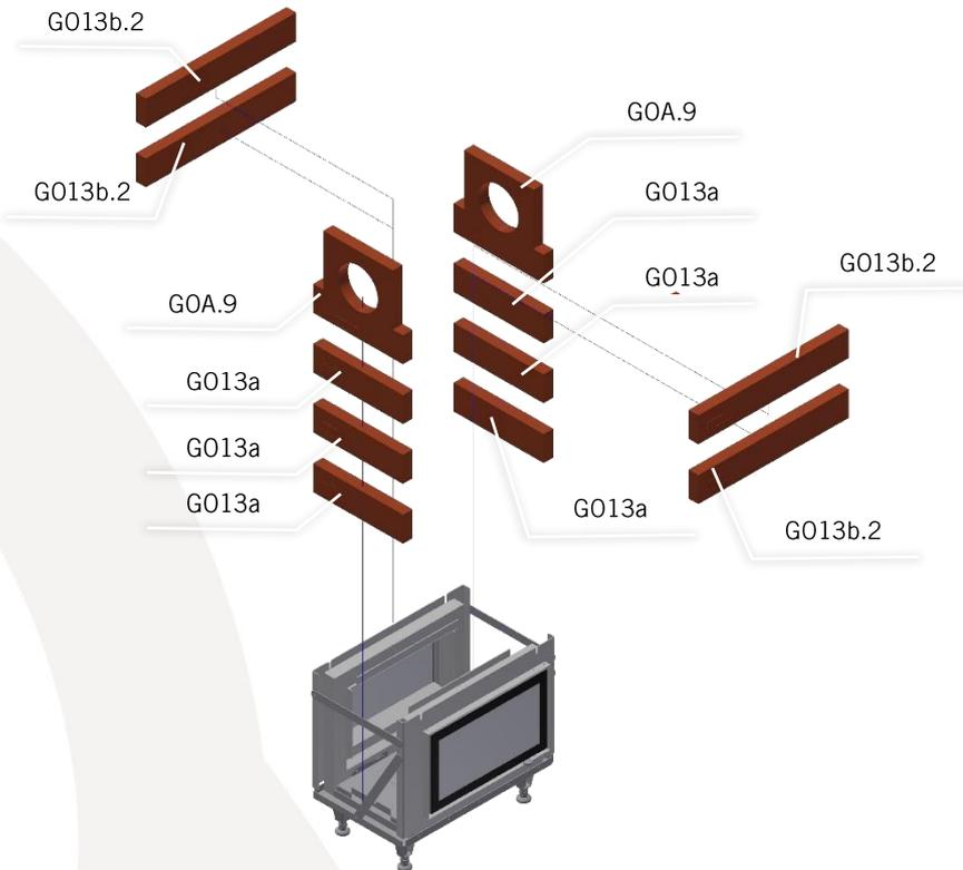
Setzen Sie zunächst die 1. Reihe der Mantelteile trocken auf die Fasermatten ins Grundgestell.
