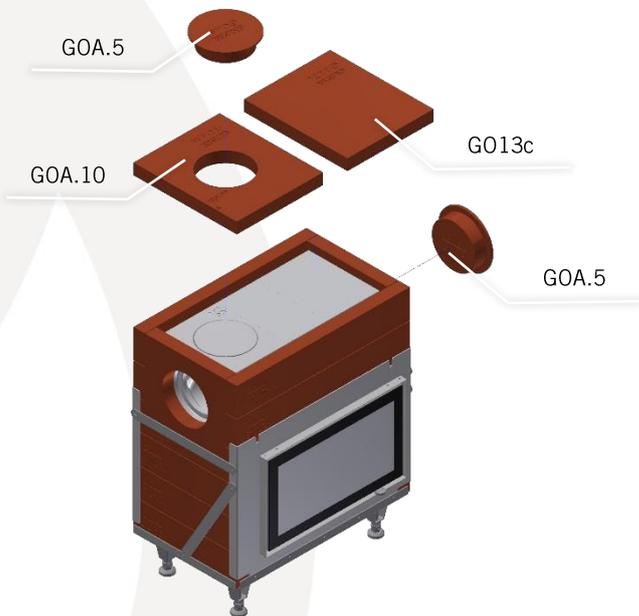
Verkleben Sie den Deckel des Mantels mit den Seitenteilen. Verwenden sie dazu den ORTNER Versetzmörtel HK.
