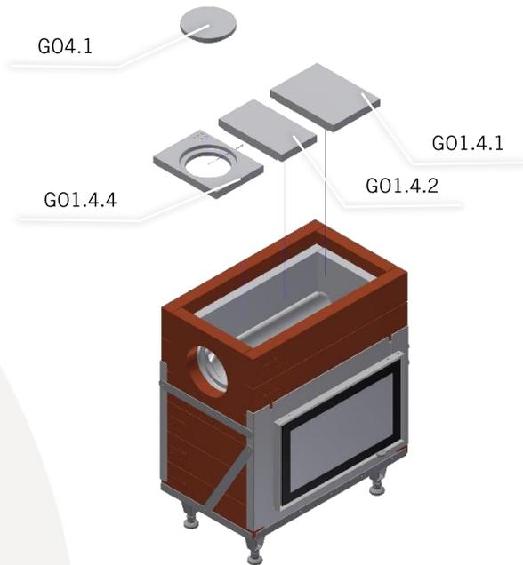
Positionieren Sie nun die Abdeckung der Nachbrennkammer, je nach Position des Ausbrandes.
