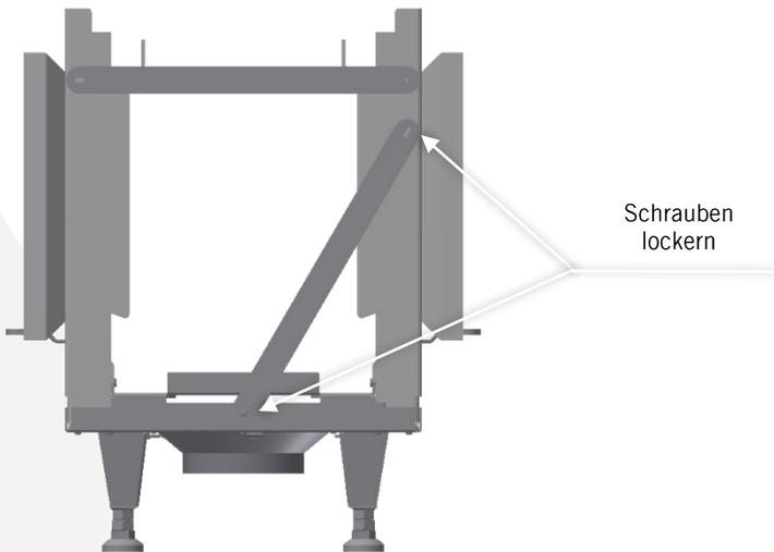
Stellen Sie das Grundgestell auf, richten Sie den Bodenteil in die Waage, und schließen Sie bei Bedarf den Aluflexschlauch für die Verbrennungsluftversorgung an.
