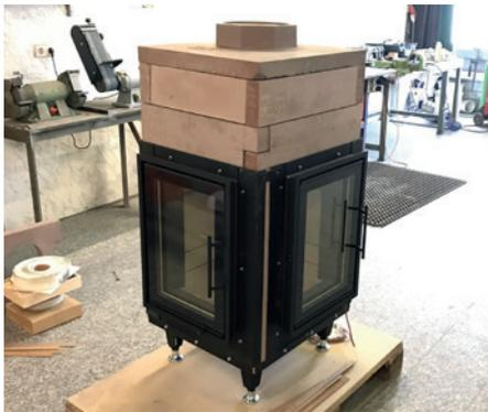
GO16-42/59 mit seitlich eingebauter HTplus 42/59 Türeinheit.
