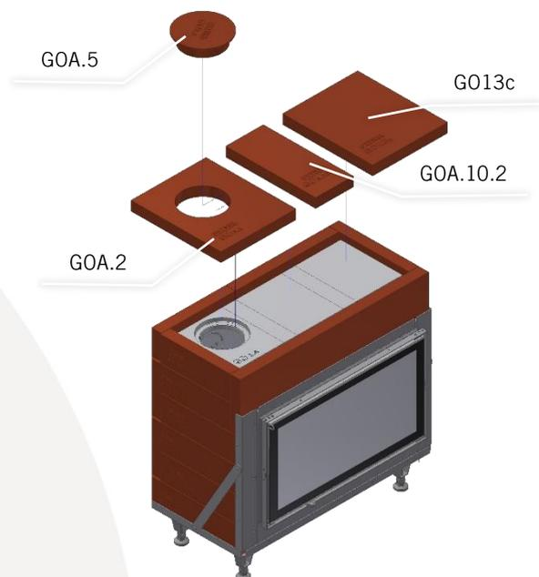
Verkleben Sie den Deckel des Mantels mit den Seitenteilen.
