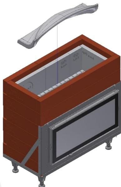
Positionieren Sie die Umlenplatte auf den GOS, und schieben Sie diese immer ganz nach hinten und zur Seite des Ausbrandes.
