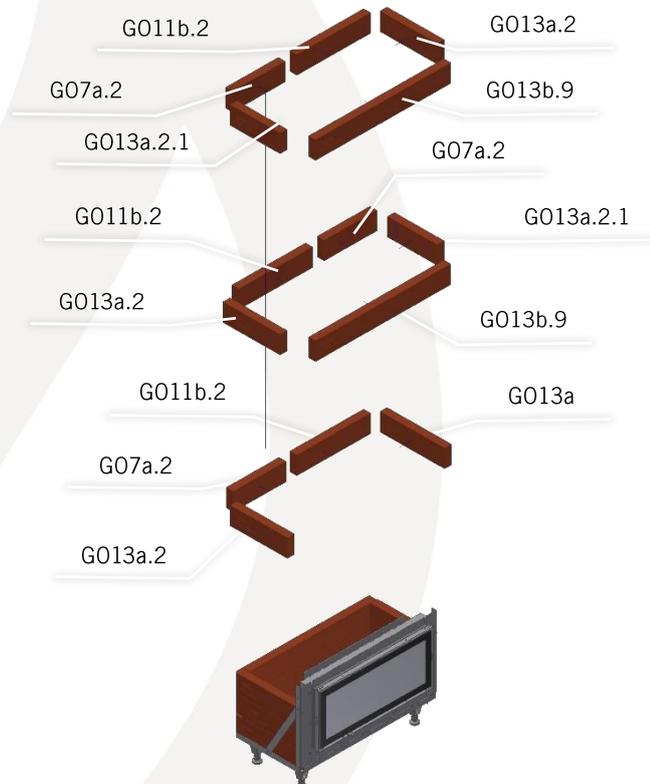
Bevor Sie mit den Mantelsteinen über die Tür mauern, ist diese mittels den seitlichen Klemmleisten winkeltgerecht zur Bodenplatte auszurichten und festzuschrauben.
