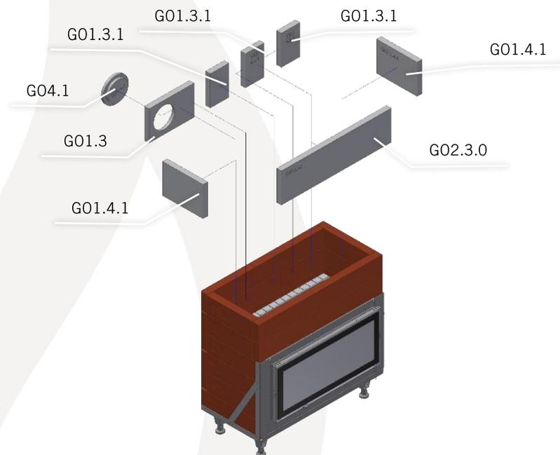
Versetzen Sie die Teile der Nachverbrennungskammer trocken. Bei nicht geschlossenen Fugen (abhängig von der Fugenstärke beim Aufbau der roten Mantelsteine sind die Fugen mit Keramikfaser abzudichten. Die Nachverbrennung ist jedoch nicht untereinander zu Verkleben.
