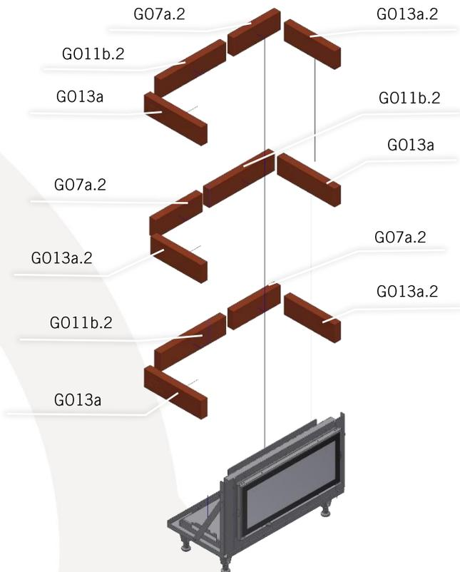
Setzen Sie zunächst die 1. Reihe der Mantelteile trocken auf die Fasermatten ins Grundgestell.
