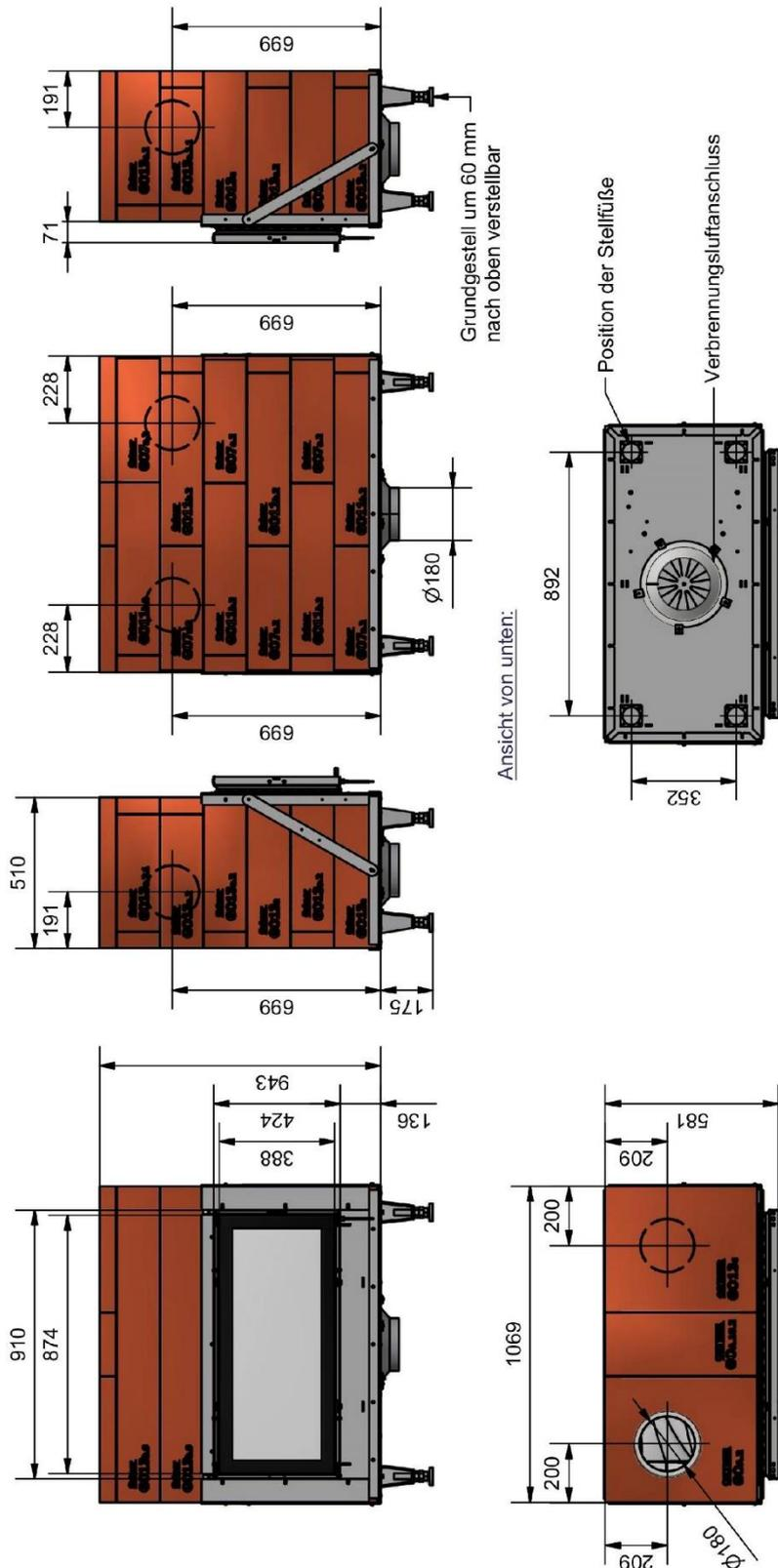
Alle Höhenangaben gelten bei einer Mörtelfugenstärke von 3 mm, einer Fasermattenstärke von 3 mm (im zusammengepressten Zustand) und vollständig nach unten geschraubtem Grundgestell.
