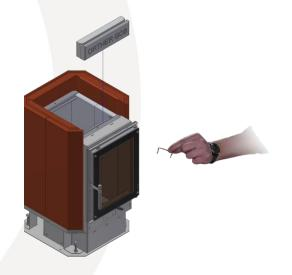
Tragen Sie Isoboardkleber auf den Frontstein auf. Positionieren Sie den mit Frontstein auf der Türeinheit und verklammern Sie diesen mit den Mantelteilen. Klopfen Sie diese eventuell leicht mit einem Hammer zusammen, um einen festen Halt der Klammern zu gewährleisten.
