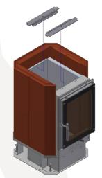
Legen Sie die Auflagebleche für die Faserteile ein. Achten Sie dabei darauf, dass die Nuten der Bleche ordentlich in den "Zäpfchen" der Türeinheit einrasten.
