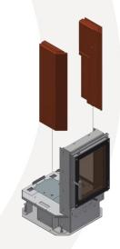
Positionieren Sie die beiden seitlichen Mantelteile.
