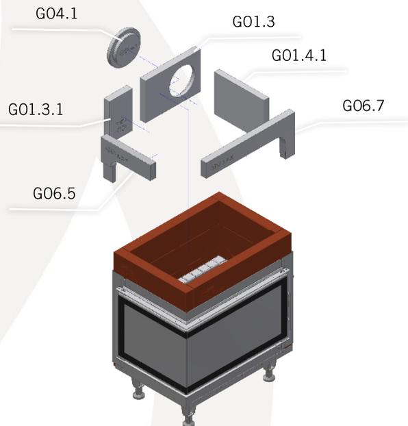
Versetzen Sie die Teile der Nachverbrennungskammer trocken. Bei nicht geschlossenen Fugen (abhängig von der Fugenstärke beim Aufbau der roten Mantelsteine) sind die Fugen mit Keramikfaser abzudichten. Die Nachverbrennung ist jedoch nicht untereinander zu verkleben.
