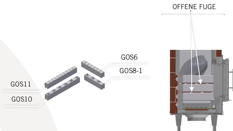
Setzen Sie nun die restlichen Reihen der GOS auf. Dabei muss in jeder Reihe umlaufend ein 6 mm Luftspalt zwischen den Steinen entstehen.
