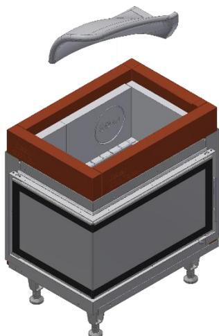
Positionieren Sie die Umlenkplatte auf den GOS, und schieben Sie diese immer ganz nach hinten und zur Seite des Ausbrandes.
