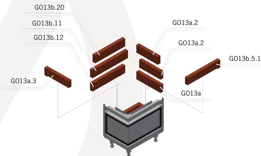
Bevor Sie mit den Mantelsteinen über die Tür mauern, ist diese mittels den seitlichen Klemmleisten winkeltrecht zur Bodenplatte auszurichten und festzuschrauben.
