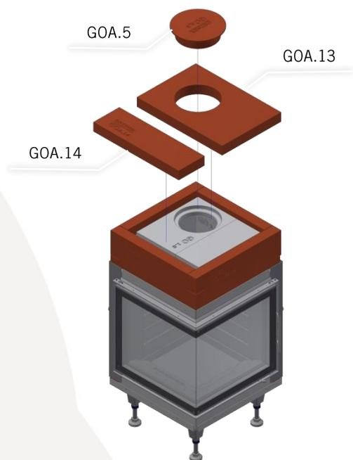
Verkleben Sie den Deckel des Mantels mit den Seitenteilen.
