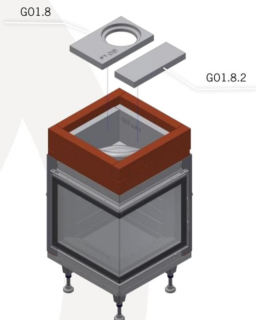
Positionieren Sie nun die Abdeckung der Nachbrennkammer.
