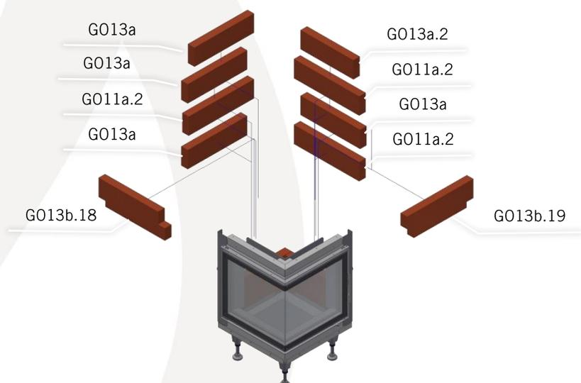
Bevor Sie mit den Mantelsteinen über die Tür mauern, ist diese mittels den seitlichen Klemmleisten winkeltrecht zur Bodenplatte auszurichten und festzuschrauben.
