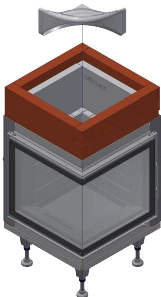
Positionieren Sie die Umlenkplatte auf den GOS, und schieben Sie diese immer ganz nach hinten und zur Seite des Ausbrandes.
