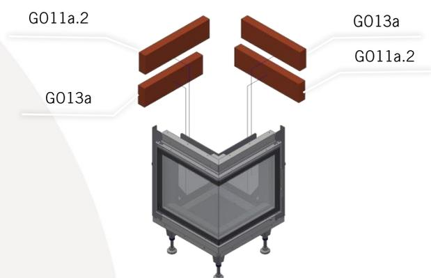
Setzen Sie zunächst die 1. Reihe der Mantelteile trocken auf die Fasermatten ins Grundgestell.
