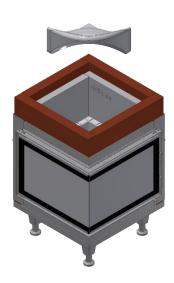
Positionieren Sie die Umlenkplatte auf den GOS, und schieben Sie diese immer ganz nach hinten und zur Seite des Ausbrandes.
