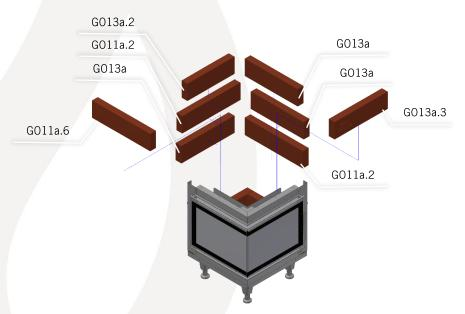
Bevor Sie mit den Mantelsteinen über die Tür mauern, ist diese mittels den seitlichen Klemmleisten winkelgerecht zur Bodenplatte auszurichten und festzuschrauben.
