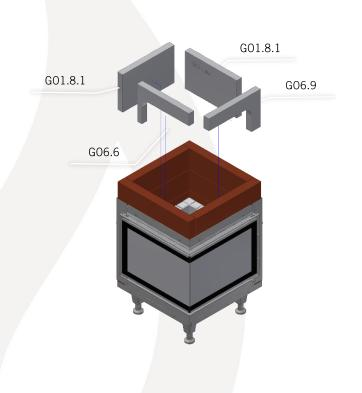
Versetzen Sie die Teile der Nachverbrennungskammer trocken. Bei nicht geschlossenen Fugen (abhängig von der Fugenstärke beim Aufbau der roten Mantelsteine) sind die Fugen mit Keramikfaser abzudichten. Die Nachverbrennung ist jedoch nicht untereinander zu verkleben.
