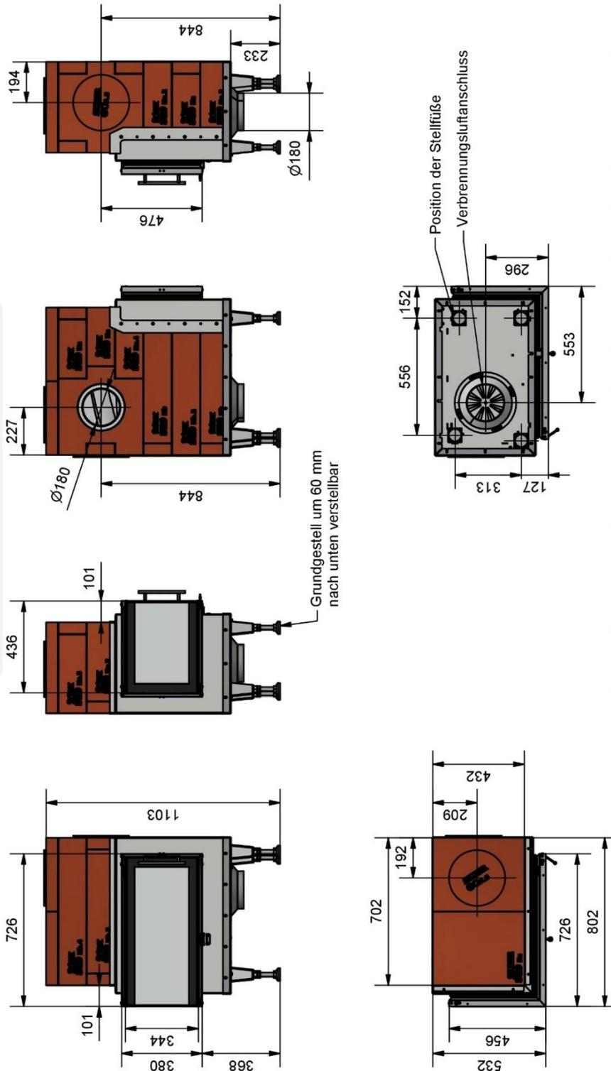
Alle Höhenangaben gelten bei einer Mörtelfugenstärke von 3 mm, einer Faserplattenstärke von 3 mm (im zusammengepressten Zustand) und vollständig hochgeschraubtem Grundgestell.
