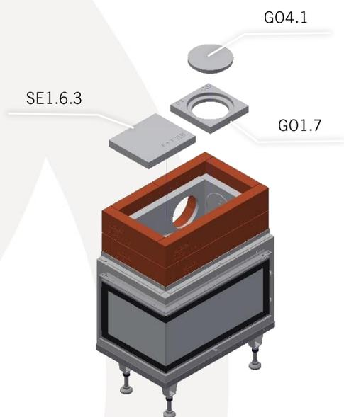
Positionieren Sie nun die Abdeckung der Nachbrennkammer.
