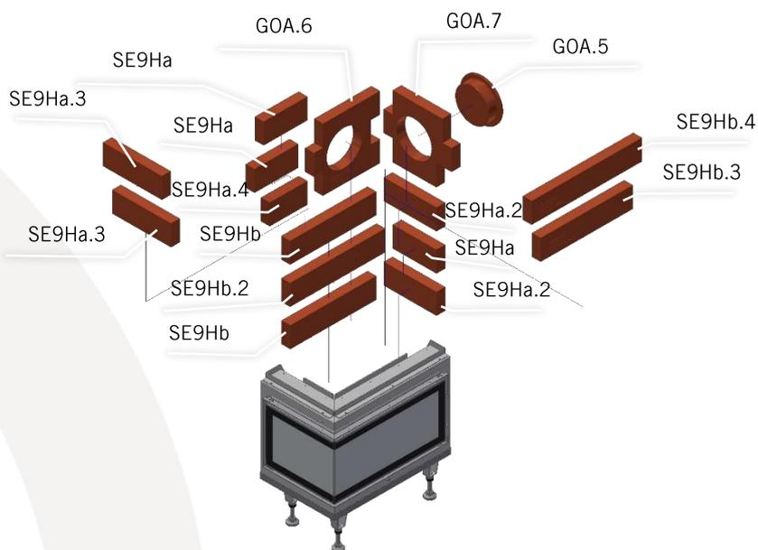
Setzen Sie zunächst die 1. Reihe der Mantelteile trocken auf die Faserplatten ins Grundgestell.
