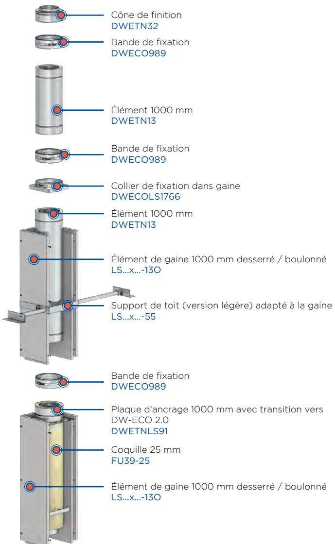
Les bande de fixation nécessaires sont incluses.
