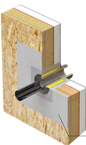
Accessoires: Plaque de radioprotection pour mur combustible
