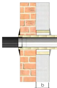
Profondeur des éléments b ≤ 180 mm
