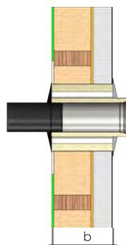
Profondeur des éléments b ≤ 360 mm
