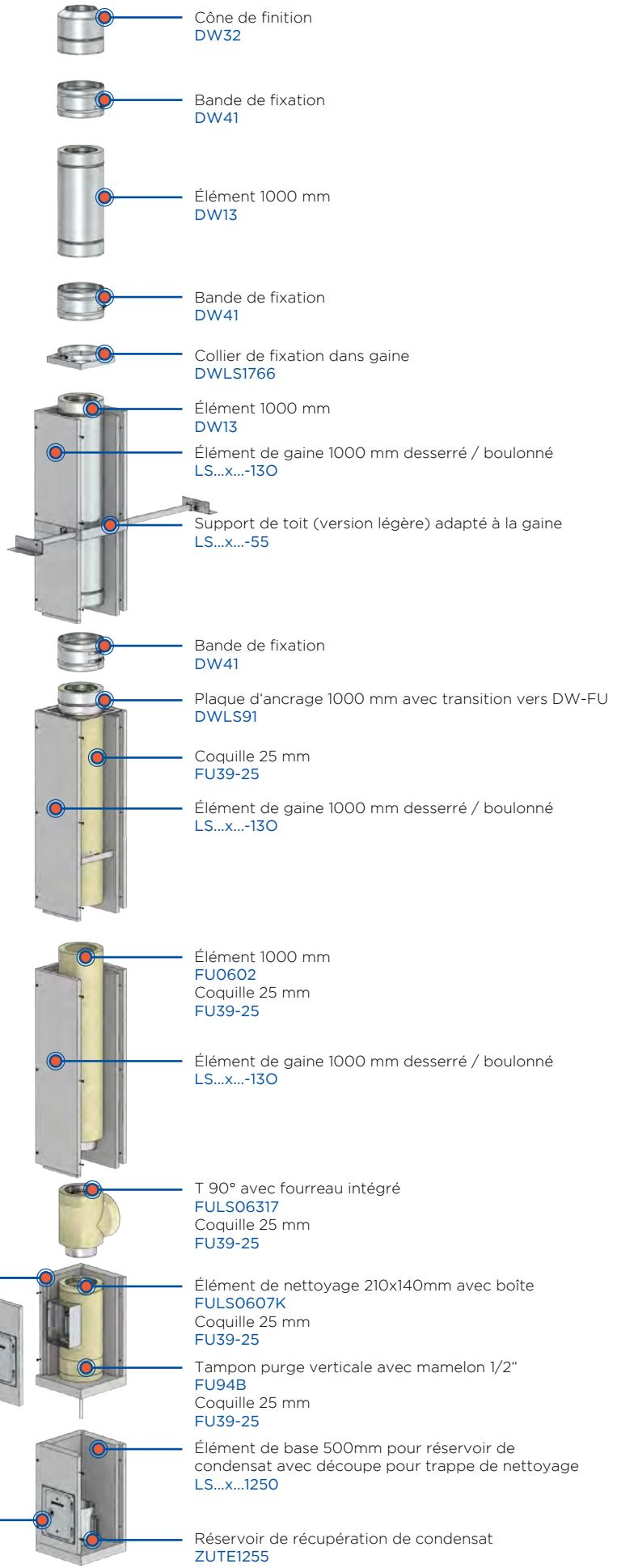
Élément de base 500 mm pour réservoir de condensat avec découpe pour trappe de nettoyage
