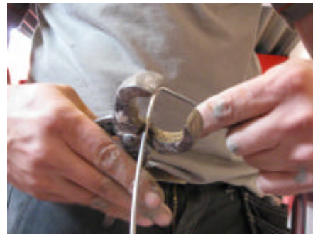
Hafnerdraht zu einer Klammer biegen.
