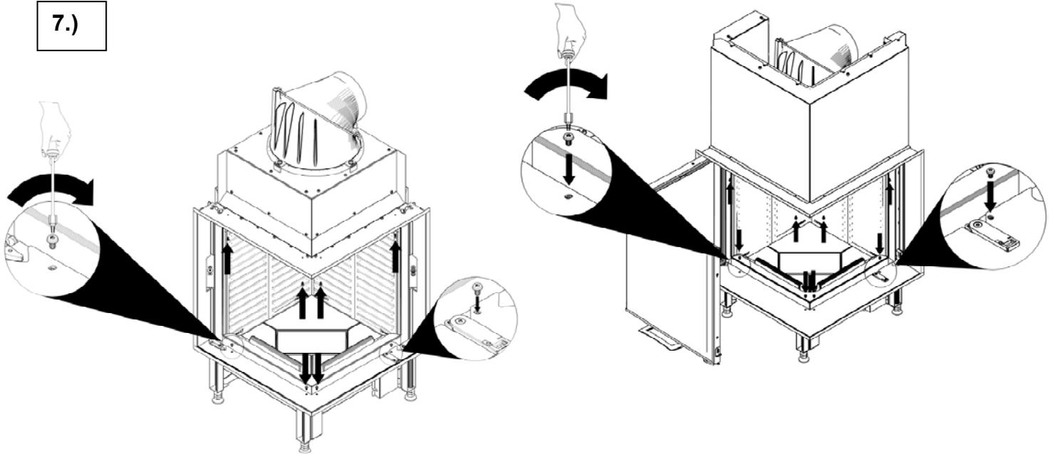
Klapptür in umgekehrter Reihenfolge(4 - 1) zusammenbauen.
